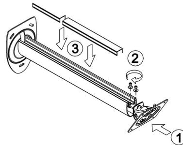
DESGLIZAR LA TAPA INFERIOR CON LA ROTULA INCORPORADA EN EL PERFIL, FIJAR LOS TORNILLOS Y POR ULTIMO VOLVER A COLOCAR LAS SECCIONES DE TAPA FRONTAL
