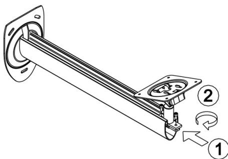
EN EL CASO DE LOS MODELOS CON ESTRUCTURA DE PANTALLA INCLINABLE Y/O GIRO O DE HABER SOLICITADO EL ANCLAJE VESA O EL ANCLAJE ROTULA EN POSICION FRONTAL SE DEBERA DESGLIZAR EL ANCLAJE VESA/ROTULA O EL ANCLAJE ESPECIAL GIRO EN EL PERFIL SEGUN IMAGEN, A CONTINUACION DESGLIZAR LA TAPA CIEGA INFERIOR, AJUSTAR LOS TORNILLOS Y VOLVER A COLOCAR LAS SECCIONES DE TAPA FRONTAL.
