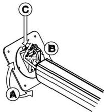
EN CASO DE SOPORTES CON VESA TIPO ROTULA, REGULAR LA POSICION DE LA PANTALLA: LEVANTAR LA PALANCA (B), REGULAR LA ORIENTACION (A) Y VOLVER A APRETAR LA PALANCA (B). EN CASO DE QUE POR EL PESO DE LA PANTALLA FUERA NECESARIO DAR UN AJUSTE MAYOR, APRETAR A TOPE EL TORNILLO (C).
