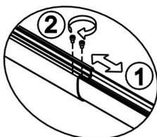
EN EL CASO DE MODELOS EXTENSIBLES, ANTES DE COLOCAR LAS SECCIONES DE TAPA FRONTAL, FIJAR LA LONGITUD DEL SOPORTE Y AJUSTAR LOS TORNILLOS
