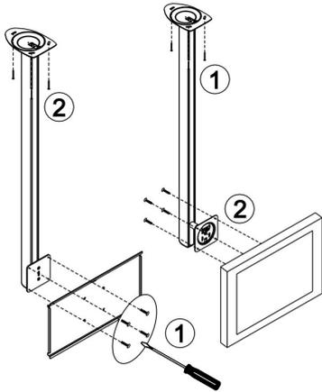
EN EL CASO DE MODELOS CON ESTRUCTURA, FIJAR LA ESTRUCTURA AL VESA MEDIANTE LOS TORNILLOS EN DOTACION. POSTERIORMENTE FIJAR TODO EL CONJUNTO AL TECHO, TAMBIEN SE PODRA FIJAR PRIMERO SOLO EL ESCUDO AL TECHO Y DESPUES INTRODUCIR EL PERFIL, CON LA ESTRUCTURA YA FIJADA, EN EL ESCUDO, MODIFICANDO EL PASO PRIMERO DE ESTAS INSTRUCCIONES.
