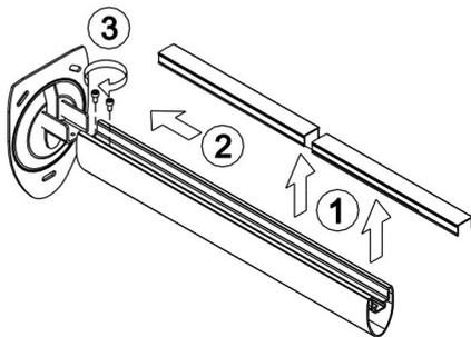
QUITAR LAS SECCIONES DE TAPA FRONTAL DEL PERFIL O PERFILES, SEGUN MODELO. INTRODUCIR EL PERFIL EN EL ESCUDO Y FIJAR AMBOS MEDIANTE LOS TORNILLOS
